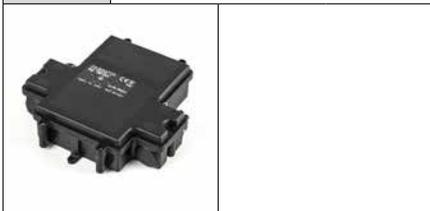
Extender IP67: unità di controllo wireless per driver LED con interfaccia di dimmerazione DALI basata su tecnologia Casambi. Dispone di una uscita DALI2 tramite la quale si possono controllare fino a 40 apparecchi di illuminazione. Con l'aggiunta di un ulteriore alimentatore BUS DALI esterno è possibile comandare fino a 64 apparecchi. Extender IP67 è preimpostato sul profilo DALI broadcast, ovvero tutti gli apparecchi collegati ad esso sono dimmerabili allo stesso livello.
