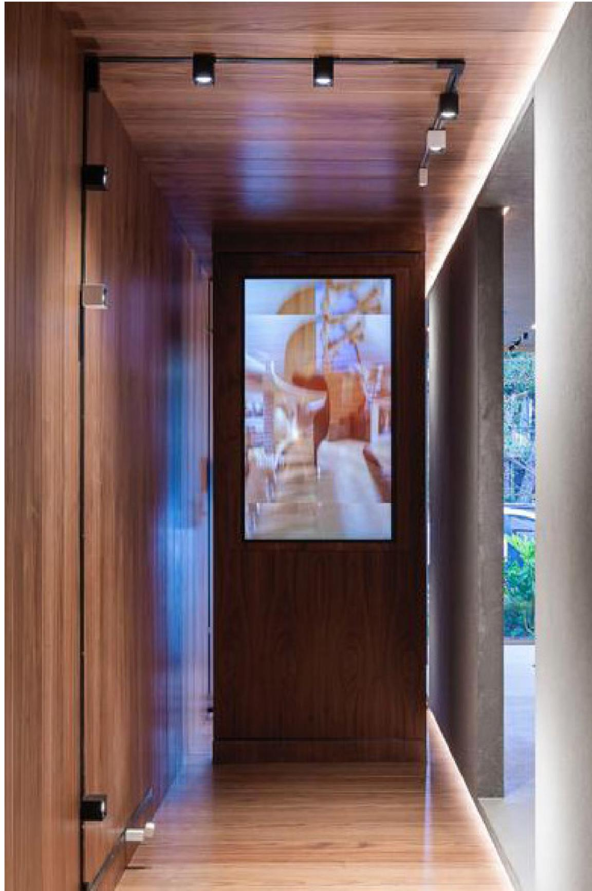
El sistema está compuesto por un avanzado riel conductor de 6 mm de espesor que serpentea por el espacio, llevando la corriente a 48V y en el que se enganchan las unidades de iluminación.
