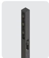
Idéal pour les grandes allées, les rampes d'accès ou toute zone nécessitant un éclairage long et étroit. Le système optique a une ouverture de 25° idéale pour éclairer des zones d'une largeur jusqu'à 4 fois la hauteur d'installation et d'une profondeur de 1,75 fois. Soit des surfaces d'environ 6m x 14m pour les poteaux de hauteur 350cm, et des surfaces de 8,75m x 20m pour les poteaux de hauteur 500cm.
