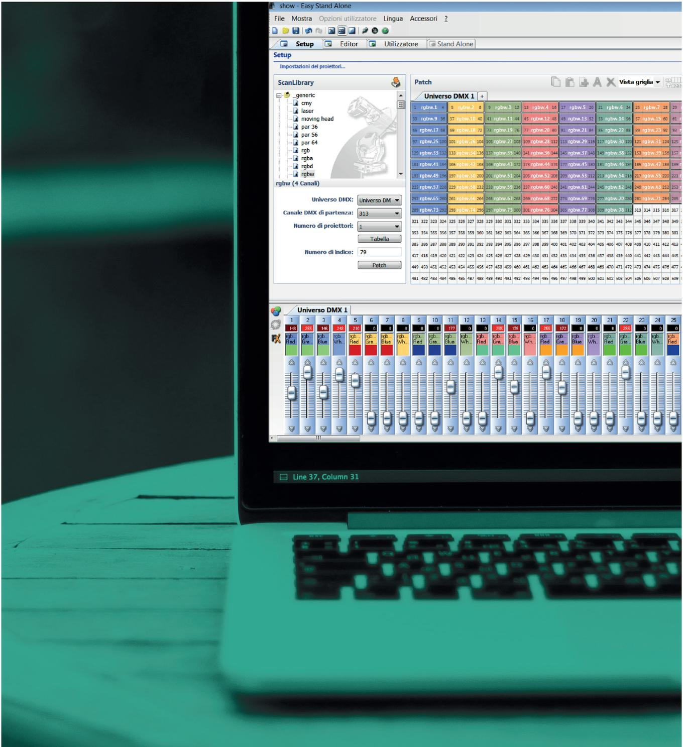
Les appareils RGB et RGBW utilisent pour la programmation et le pilotage le protocole de communication numérique DMX 512, la norme la plus répandue et testée pour le contrôle des lumières connectées. Cela permet non seulement une compatibilité optimale avec les autres appareils proposés sur le marché, mais aussi de disposer d'une grande variété d'accessoires à des prix convenables.
