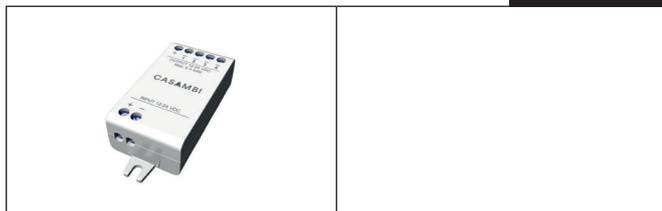
Dimmer sans fils Bluetooth capable de gérer une tension constante à 12V ou 24V des charges divisées en 4 canaux de sortie PWM. Ce dimmer se branche entre l'alimentation 12V ou 24V et le module LED à tension constante. Le courant total maximum distribué par l'unité de commande est de 6A (qui équivaut à 144 W au total) qui peut être divisé sur les quatre sorties. Compatible avec Minimercurie RGB et Micromercurie.
