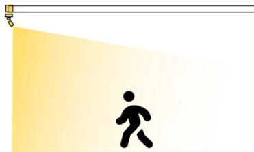
Durch den Befestigungssockel ist eine Orientierung von 0° bis 90° auf vertikaler und um 355° auf horizontaler Ebene gewährleistet. So erfasst der Sensor die Signale, wo es gewünscht wird.
