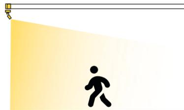
La base de fixation permet une inclinaison de 0° à 90° et une orientation à 355° de manière à pouvoir orienter le capteur là où il faut.
