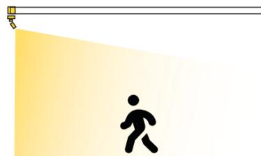
La basetta di fissaggio ne consente l'orientabilità da 0° a 90° sul piano verticale e di 355° sul piano orizzontale, così da orientare il sensore dove serve.
