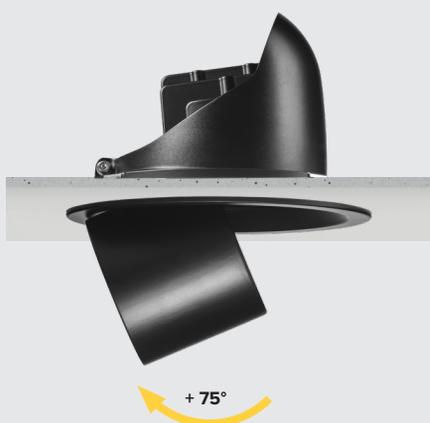
Para ambos tamaños es posible orientar el cuerpo de modo continuo de  $-25^{\circ}$  a  $75^{\circ}$  en el plano vertical y de  $355^{\circ}$  en el horizontal. El valor  $-25^{\circ}$  significa que es posible incluso retrasar el cuerpo óptico en el interior del contratecho. CCTEvo Extraíble cuenta con un kicker interno de ryton negro que cubre las posibles fugas de luz hacia el techo, independientemente de la posición asumida en fase de extracción.
