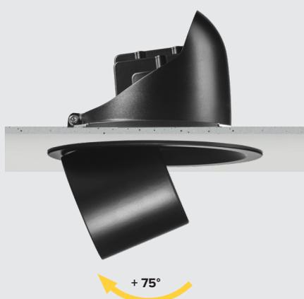
Il est possible, pour les deux tailles, d'orienter le corps de manière continue, avec une inclinaison comprise entre - 25° et 75°, et une orientation de 355°. La valeur de -25° signifie qu'il est possible de faire reculer le corps optique à l'intérieur du faux-plafond. CCTEvo extractible est doté d'un kicker interne en Ryton noir qui couvre les dispersions éventuelles de lumière vers le plafond, indépendamment de la position prise au moment de l'extraction.
