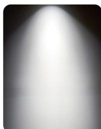
La lente è il sistema ottico più innovativo perché nato appositamente per la sorgente LED. Consente di ottenere fasci molto precisi con un gradiente di sfumatura molto morbido. Targetti ha lenti proprietarie ovvero progetta e produce
