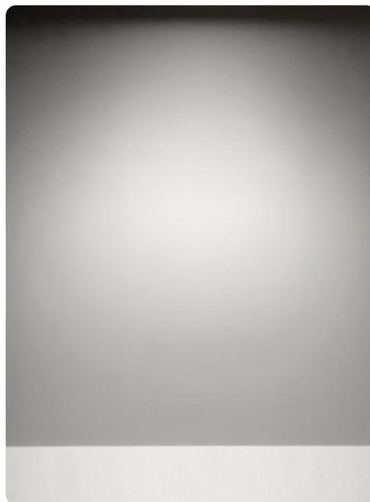
Per ottenere un effetto uniforme sull'asse verticale della superficie da illuminare, è indicato progettare con un'ottica wall washer considerando il rapporto 1 a 3. Significa che gli apparecchi devono essere distanti dalla parete da illuminare di circa un terzo la sua altezza.
