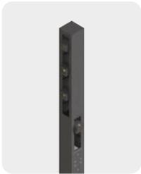
Ce type de distribution est utilisé dans les zones où il est important de pousser la lumière à la fois en profondeur et en largeur, trouvant généralement une utilisation dans des applications telles que les places. Le système optique a une ouverture de 40°, idéale pour éclairer de grandes surfaces jusqu'à 2,75 fois la hauteur de montage, soit environ 9,60 mètres pour le mât de 350 cm et 14 mètres pour le mât de 500 cm
