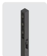
Ideale per passaggi pedonali ampi, rampe di accesso, o qualsiasi area che richieda un'illuminazione lunga e stretta. Il sistema ottico ha un'apertura di 25° ideale per illuminare aree con una larghezza fino a 4 volte l'altezza di installazione e una profondità di 1.75 volte. Quindi aree di 6m x 14m circa per i pali alti 350cm, e aree di 8.75m x 20m per i pali di 500cm.
