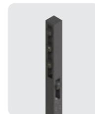
Questo tipo di distribuzione viene utilizzato dove è importante spingere la luce sia in profondità sia in ampiezza come nelle piazze e piazzali. Il sistema ottico ha un'apertura di 40°, ideale per illuminare aree ampie fino a 2,75 volte l'altezza di montaggio, quindi circa 9,60 metri per il palo da 350cm e 14 metri per il palo da 500cm.
