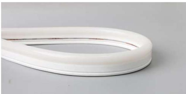
DuraNeonFlex sans bornes. Fourni par mètres, en bobine standard de 5 m, 10 m ou de 50 m ou coupé à la longueur maximale de 10 m (5 m pour DNF Twist). DNF peut être découpé sur site grâce à des points de coupe facilement identifiables. DNF peuvent être coupés tous les 5 cm, avec l'exception de DNF Twist et de DNF MINI qui n'ont pas une dimension minimale de coupage, ils sont 'coupage libre'.
