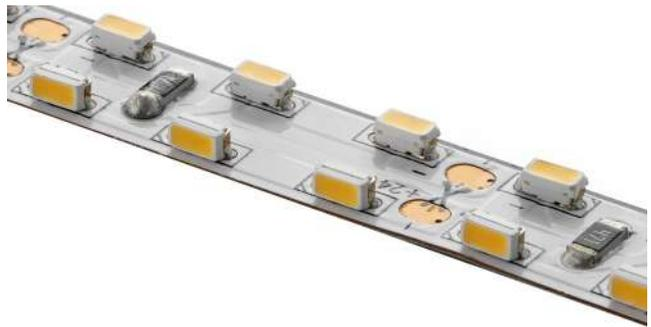
DURASTRIP bidirezionale è costruita montando i LED sul substrato in due file ortogonali: si ottiene così un'emissione luminosa asimmetrica di circa 220°. L'effetto finale si poteva precedentemente ottenere solo impiegando due strisce e con particolari accorgimenti. DURASTRIP bidirezionale costituisce un'ottimizzazione funzionale, e quindi di progetto, che trova la sua massima espressione in profili decorativi o dove si voglia ottenere l'effetto wall washer.
