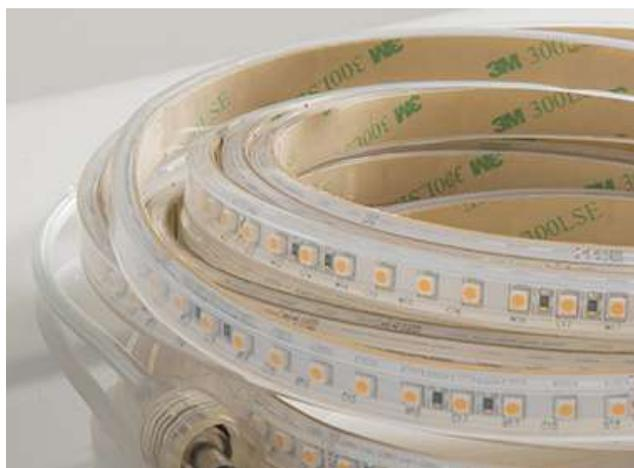
DURASTRIP PRO impiegano la tecnologia "copper shielded" (rivestimento di rame completo sul circuito su entrambi i lati del supporto) concepita dal nostro Laboratorio Ricerca e Sviluppo: la maggior quantità di rame migliora la gestione termica e garantisce durate di vita più lunghe.
