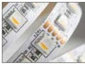
Tecnología especial de empaquetado del LED: el chip 4 en 1 permite obtener una uniformidad de emisión luminosa sin igual, con una mezcla perfecta de colores.
