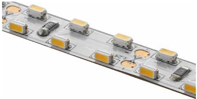
DURASTRIP bidireccional está fabricada montando los LED en el sustrato con dos filas ortogonales: se obtiene así una emisión luminosa asimétrica de aproximadamente 220°. Anteriormente, el efecto final se podía obtener utilizando solo dos tiras y con determinadas condiciones. DURASTRIP bidireccional constituye una optimización funcional y, por tanto, de proyecto, que encuentra su máxima expresión en los perfiles decorativos o donde se desee obtener el efecto wall washer.
