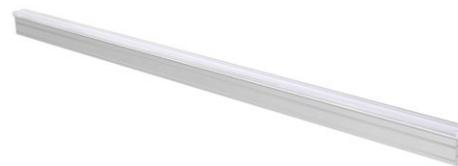
这是一款适用于建筑立面泛光的小尺寸线型灯具。灯具表面出光材料为光学级乳白和透明亚克力相结合的方立体实心柱，二者的结合，使得灯具有着优异的混光效果，既保持出光柔和，又兼具整体清透感；光束角 120°，出光可视角度可达 180°。灯具安装简便，可嵌入式安装、吸顶式安装或明装。输入电压为低压 24V，采用 DMX512 系统进行控制。
